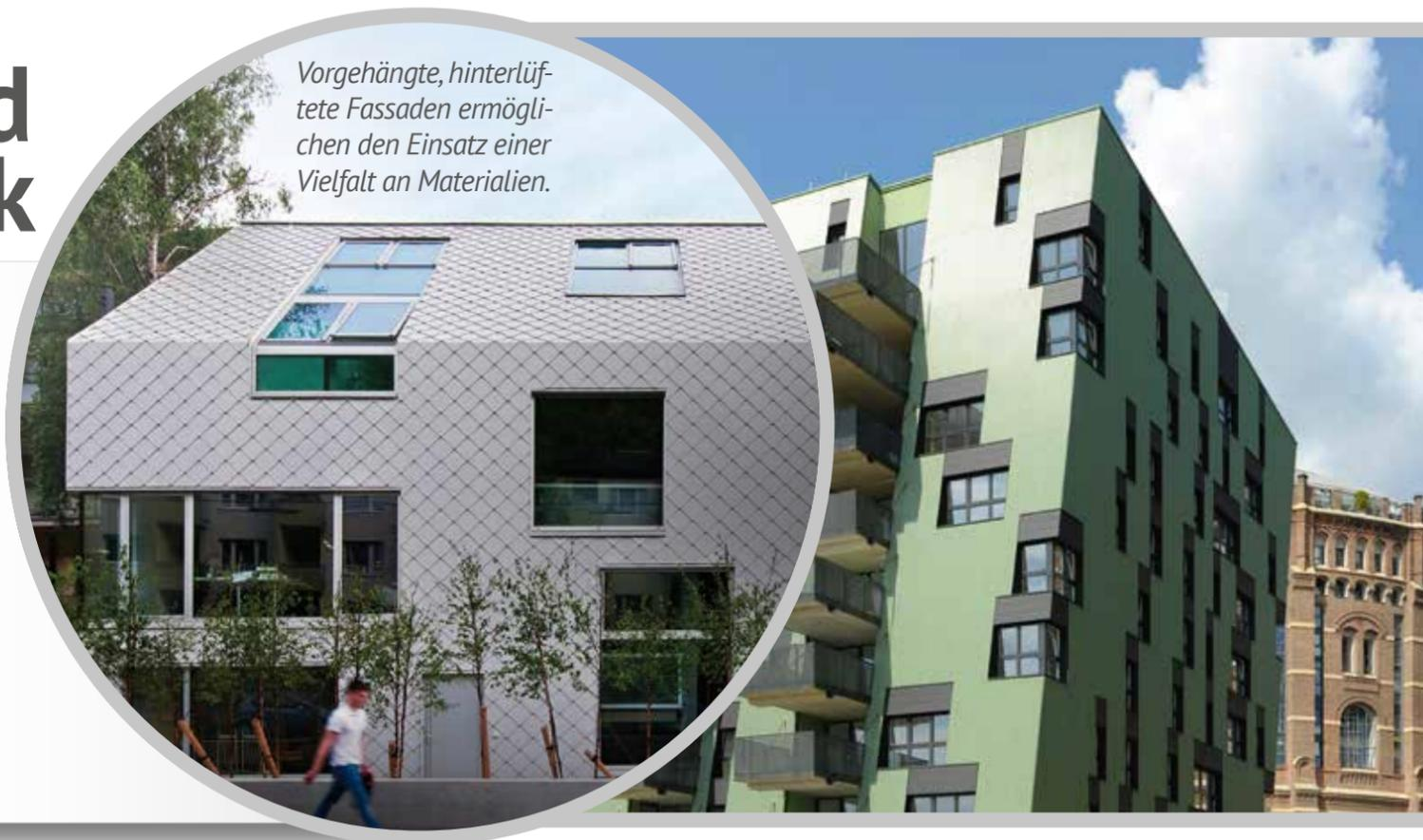
Vorgehängte, hinterlüftete Fassaden ermöglichen den Einsatz einer Vielfalt an Materialien.
